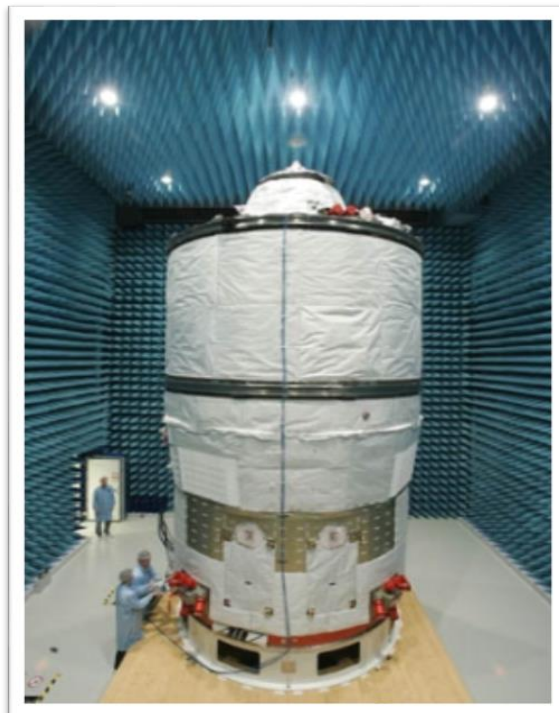
Slika 13b. Anehoična soba za merenje na stubu
